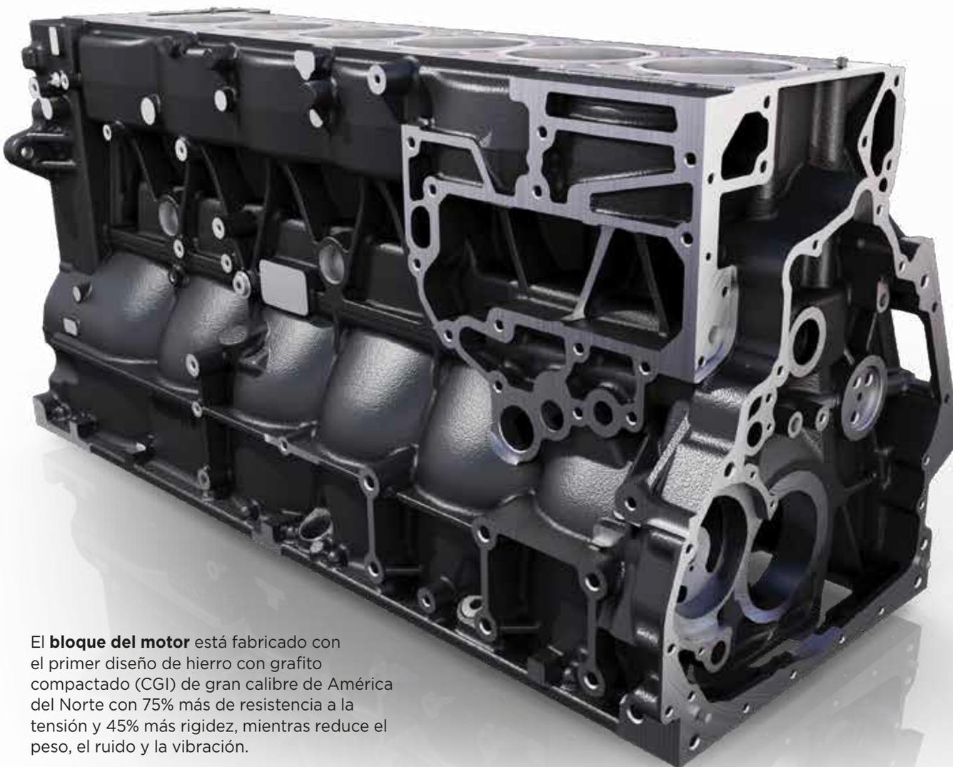
El **bloque del motor** está fabricado con el primer diseño de hierro con grafito compactado (CGI) de gran calibre de América del Norte con 75% más de resistencia a la tensión y 45% más rigidez, mientras reduce el peso, el ruido y la vibración.
